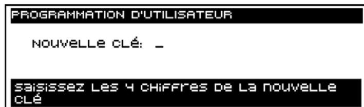
Les numéros introduits sont remplacés par des astérisques par mesure de sécurité. On nous demande ensuite de répéter le code pour le vérifier.
