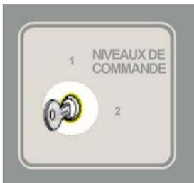
La centrale se trouve à tout moment avec un niveau d'accès déterminé. Quand elle lance le système lorsqu'on l'allume, elle fixe comme niveau d'accès actuel celui indiqué par la clé du panneau frontal, c'est-à-dire, niveau 1 ou 2.
