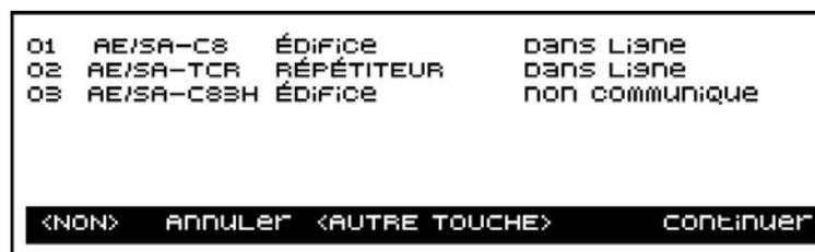
Si le réseau AE2NET n'est pas opérant, le message d'erreur suivant apparaît:
